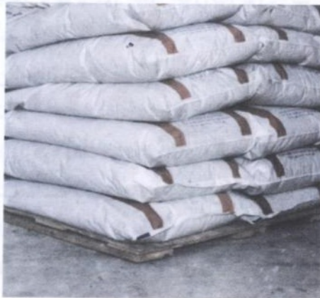
شکل شماره ۸: استفاده از پالت برای نگهداری کیسه‌ها در انبار ضروری است
